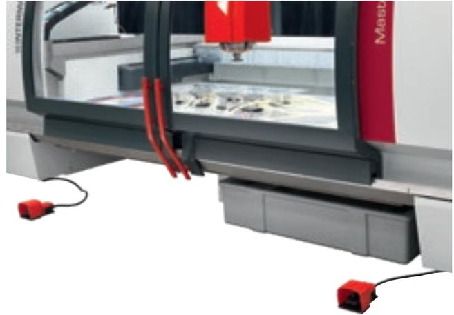
Schnelles Werkstückeinspannsystem mit Vakuum dank des serienmäßigen doppelten Pedals in der Maschine.
