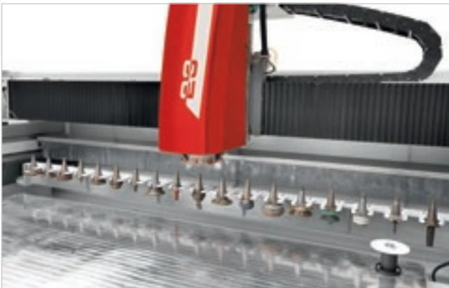
Werkzeugwechsel an der Rückseite mit Gehäuse zum Schutz gegen Bearbeitungsreste für die Kegel mit 18 Positionen und automatischem Laden des Werkzeugs über die Arbeitsgruppe.
