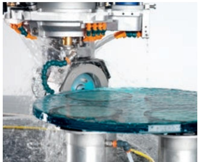
Topfschleifen und -polieren mit Aggregat.
