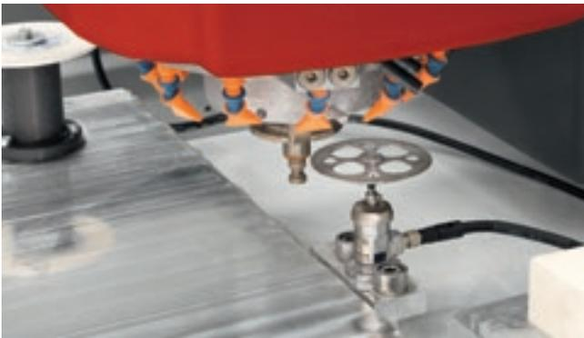
Master 23 kann mit mechanischen Presetter ausgerüstet werden, der dank des vollkommen automatischen Systems bei größter Einfachheit und Schnelligkeit eine stets präzise und aktualisierte Messung der Werkzeuge während der Bearbeitungsverfahren ermöglicht, so dass jegliche Fehler von Seiten des Bedieners vermieden werden.
